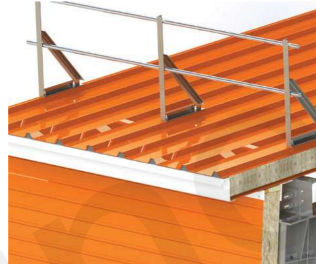
1.10.1 - Крепление кровельного ограждения
