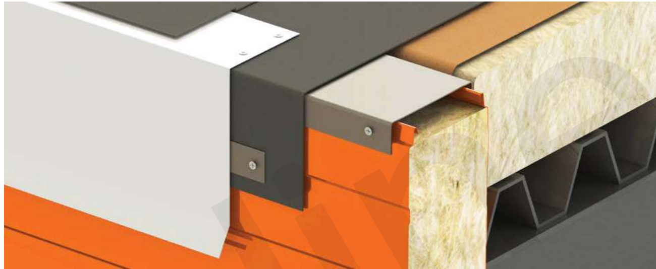
2.11 - Примыкание стеновой панели к плоской кровле без парапета с гидроизоляцией из рулонных кровельных материалов
