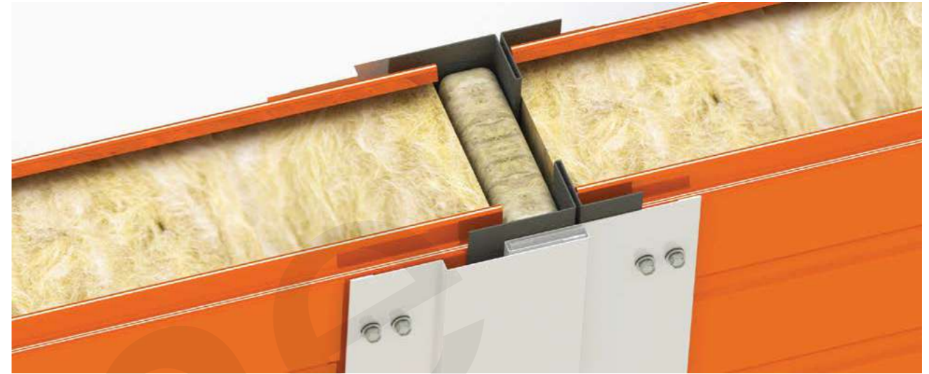
2.8 - Деформационный шов в стеновых панелях
