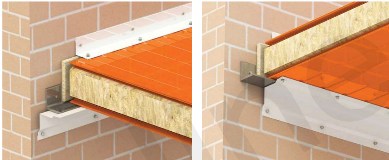
7.3 - Крепление подвесного потолка к кирпичной стене
