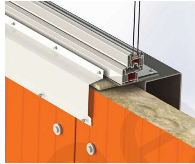
5.8.2 - Низ оконного, дверного проёма
