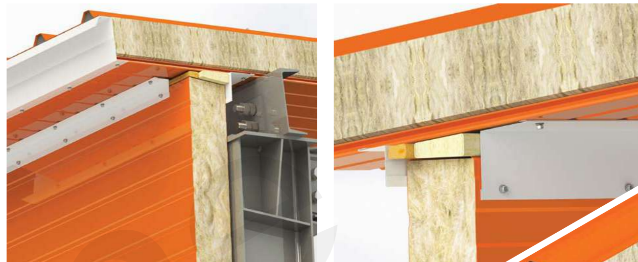
1.8.2 Свес кровли не более 300мм, неорганизованный водосток/ с подрезкой утеплителя
