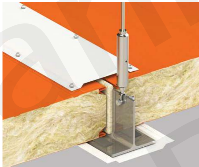
7.1 - Крепление подвесного потолка к металлической балке
