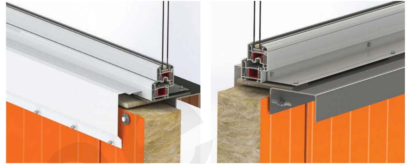
5.11.2 - Низ оконного/дверного проема
