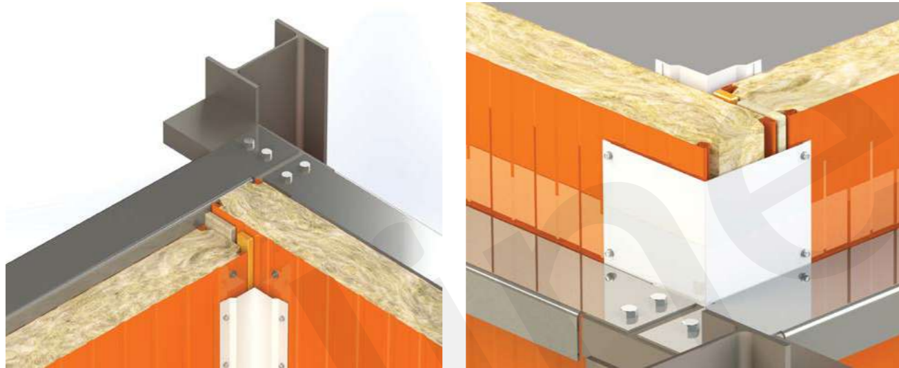
2.3.2 - Внутренний угол. Вертикальная раскладка
