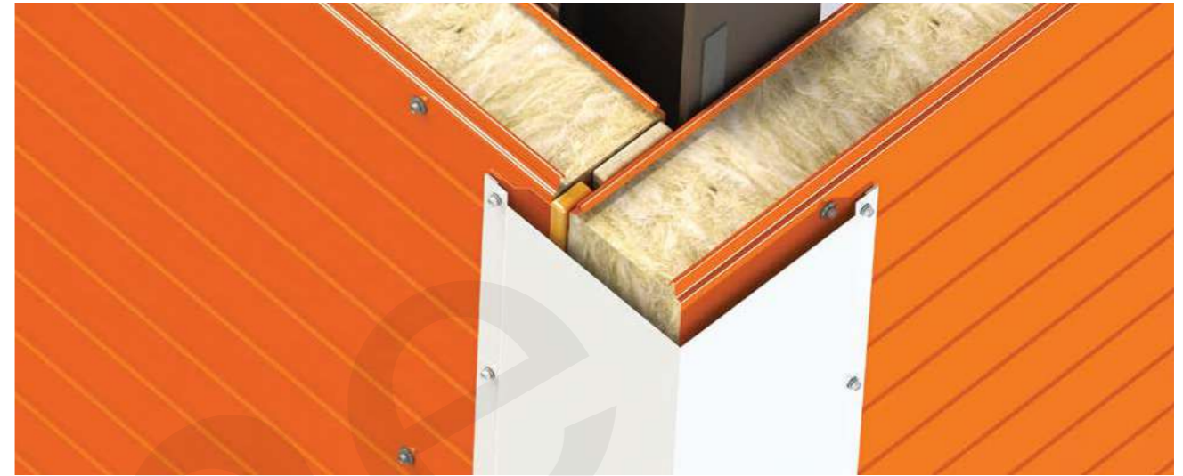
2.2.1 - Наружный угол. Горизонтальная раскладка
