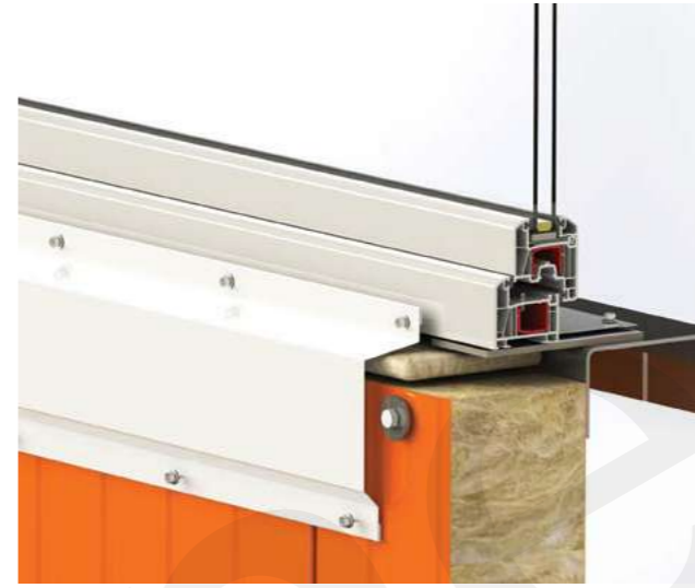
5.10.2 - Низ оконного/дверного проема
