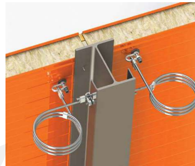
6.1 - Крепление сбрасываемых при взрыве стеновых сэндвич-панелей
