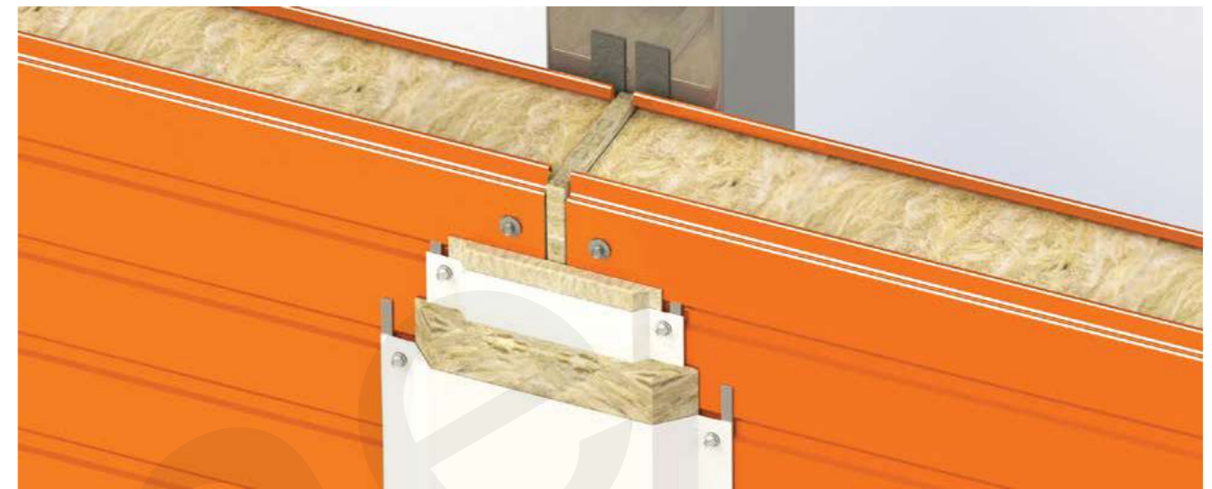
4.3.1 - Стык панелей на колонне
