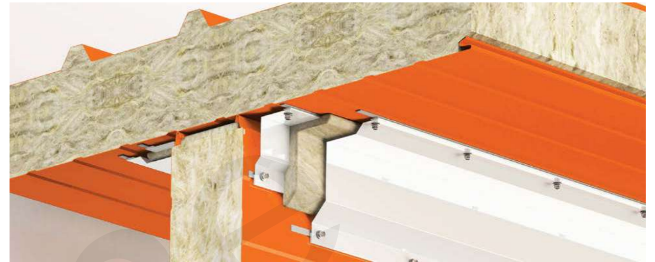
4.6.2 - Примыкание стеновой панели к кровле
