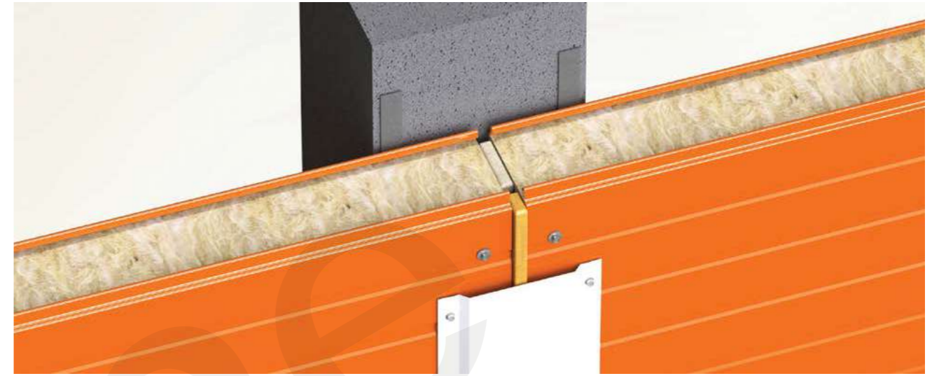
2.1.3 - Стык стеновых панелей на Ж/Б колонне
