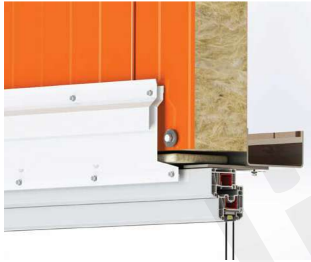
5.10.1 - Верх оконного, дверного проёма
