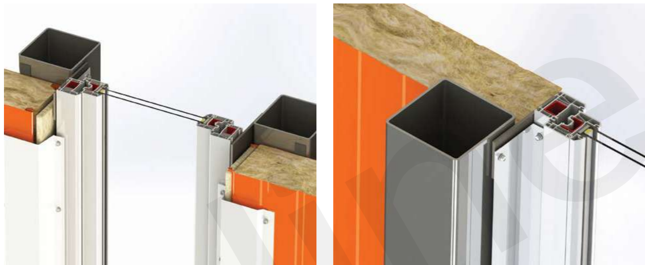
3.2.2 - Оконные и дверные проёмы. Вертикальная раскладка
