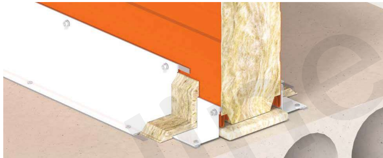
4.2 - Примыкание стеновой панели к перекрытию
