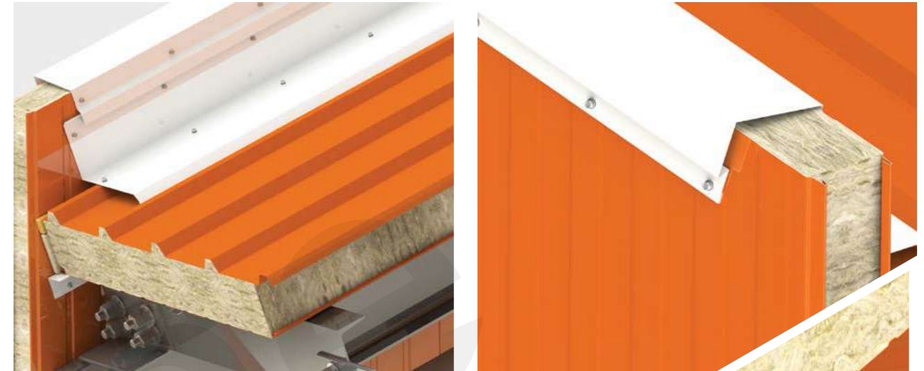
1.13.1 - Парапет не более 600 мм
