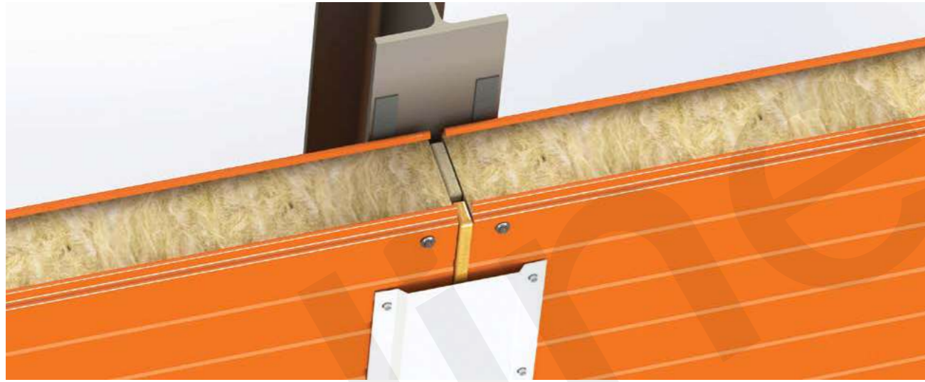
2.1.2 - Стык горизонтальных стеновых панелей
