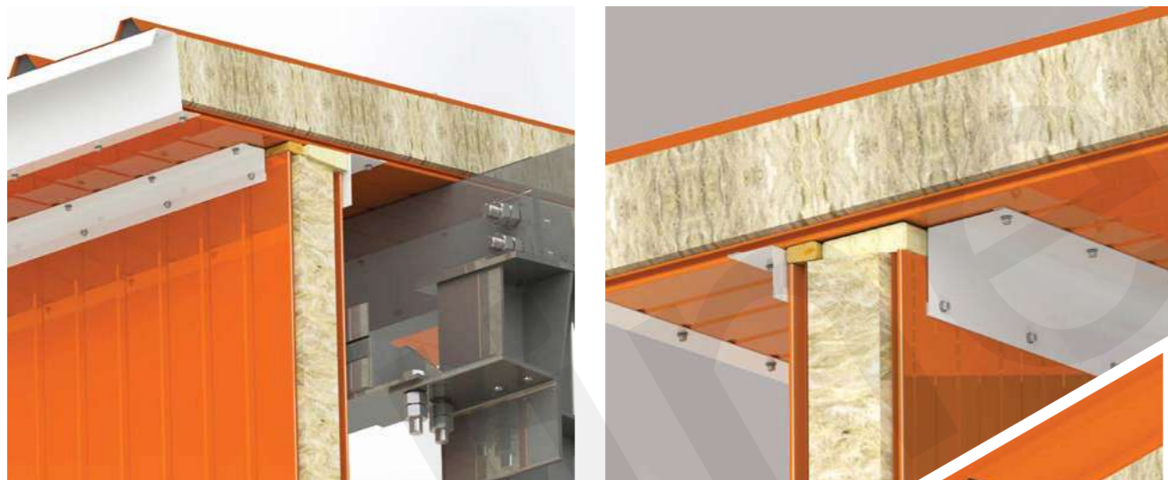
1.8.1 Свес кровли не более 300мм, неорганизованный водосток/с подрезкой металла и утеплителя
