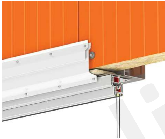
5.8.1 - Верх оконного, дверного проёма
