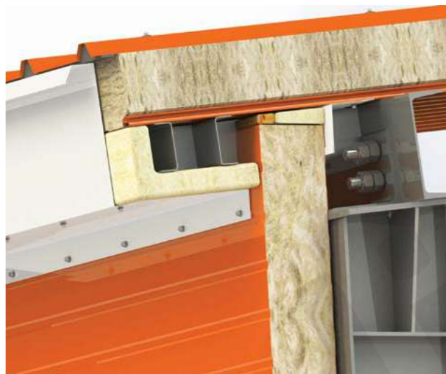
1.8.3 Свес кровли более 300мм, неорганизованный водосток
