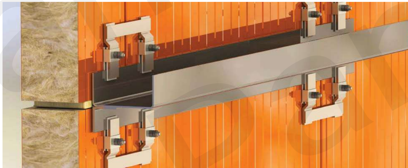
5.7 - Стык 1-го и 2-го ярусов панелей. Двухъярусное расположение панелей. Стык двух верхних ярусов панелей. Трёхъярусное и более расположение панелей
